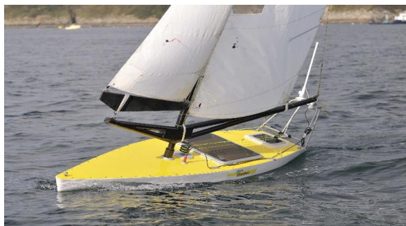
Le robot voilier VAIMOS - «Voilier Autonome Instrumenté de Mesures Océanographiques de Surface» - utilise la force du vent et l'énergie solaire pour des missions de mesures et d'observations.
