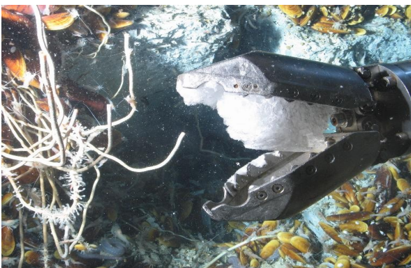
La pince du ROV Victor 6000 (robot téléopéré de l'Ifremer) contenant une bouchée d'hydrate de gaz
