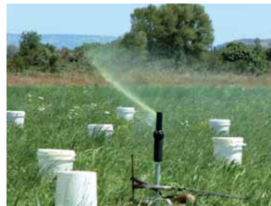
Évaluation de la dérive d'aérosols sous aspersion, avec des eaux additionnées de colorant, pour simuler une eau usée.
