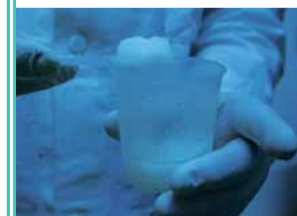
Matériau à changement de phase pour le stockage du froid.
